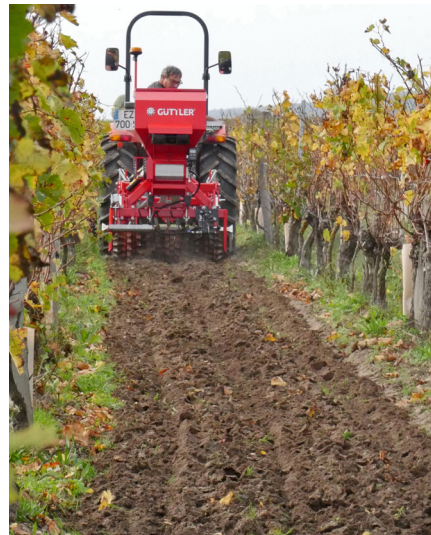
Bien qu'imposant et lourd, le semoir GreenManager du constructeur allemand Guttler permet de semer deux types de graines à des profondeurs différentes.
