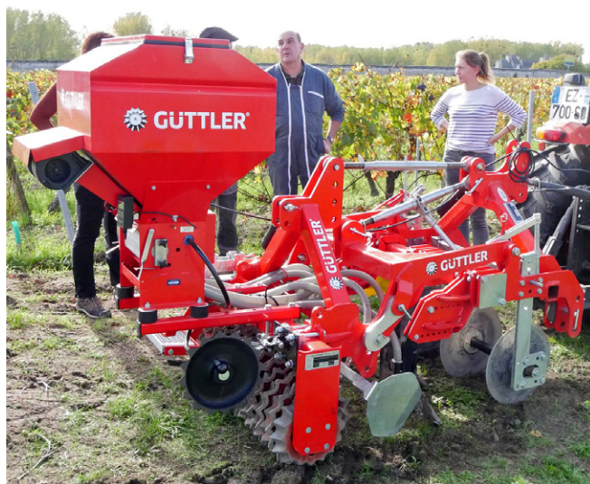
Bien qu'imposant et lourd, le semoir GreenManager du constructeur allemand Guttler permet de semer deux types de graines à des profondeurs différentes.
